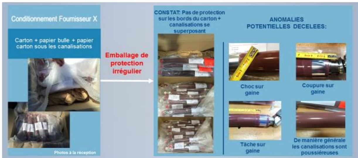
Figure 17: Constatations d'anomalies à l'ouverture des colis du Fournisseur X [source : auteur]
