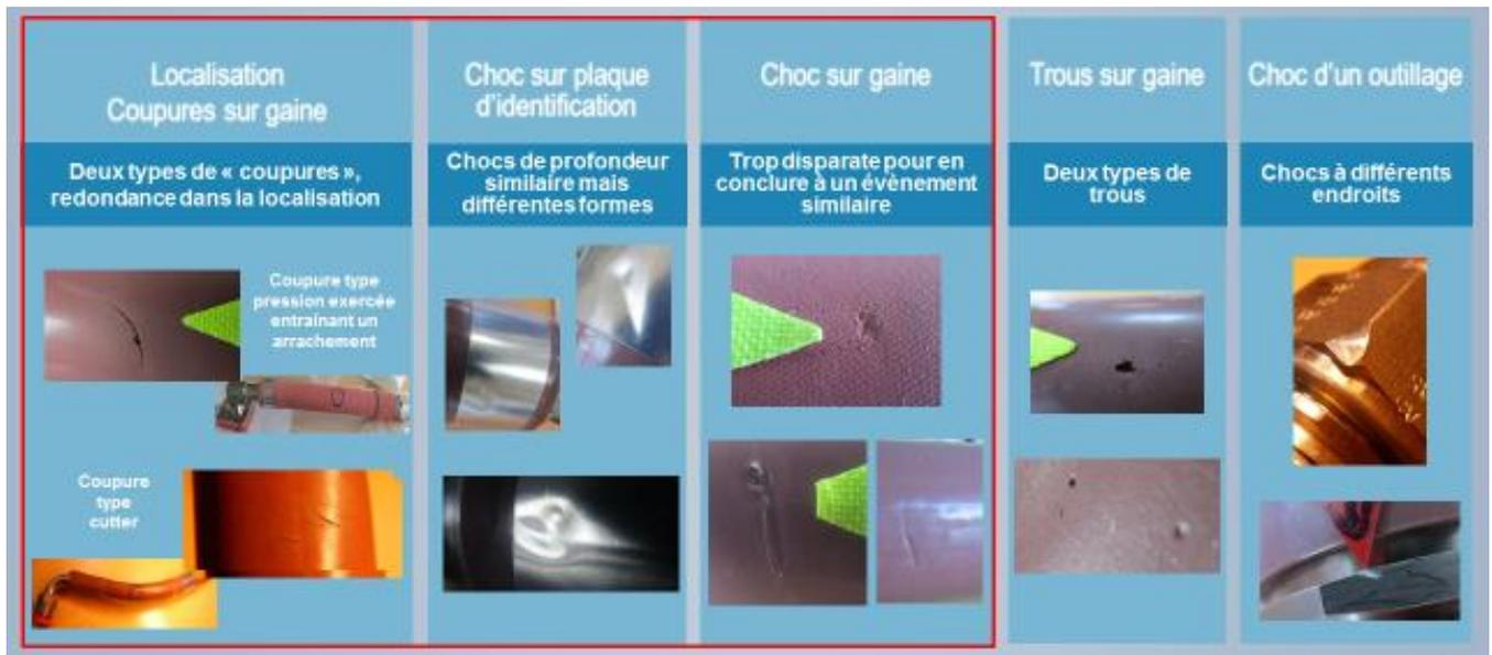
Figure 11: Photographies du top 5 des typologies d'anomalies [source : auteur]
