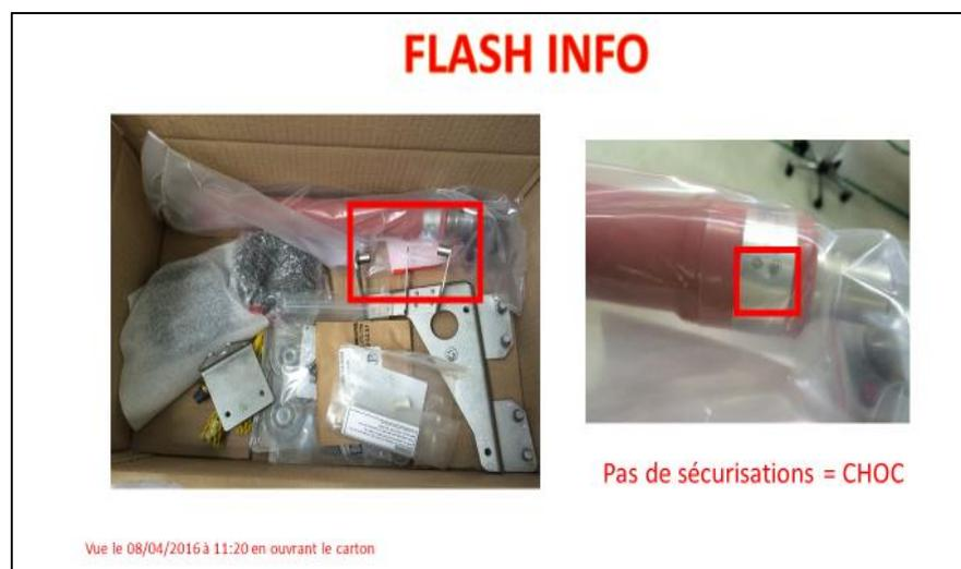
Figure 16: Flash info standard non respecté entrainant une anomalie sur plaque d'identification [source : auteur]
